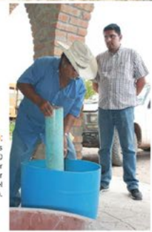
Paso 6: Colocar la mezcla en las cubetas en capas de 10 centímetros y apisonar para compactar, repetir este proceso hasta el llenado de la cubeta.
